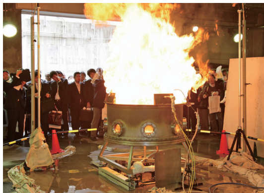
写真3 泡消火のメカニズム解明のための燃焼実験
