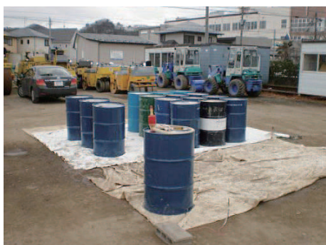
空き地にドラム缶で危険物を貯蔵している様子
